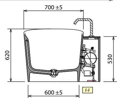
\* Bereich für die Vorbereitung des elektrischen Anschlusses für Wannen mit Rundum-Beleuchtung. Planen Sie eine Fernbedienung zum Ein- und Ausschalten (ist nicht im Lieferumfang enthalten).
